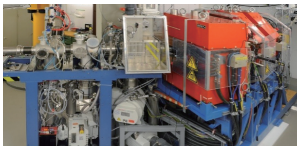
用于合成钷-252的充气反冲分离器
